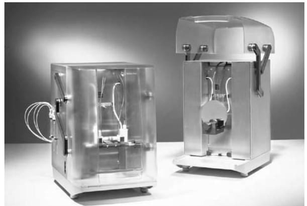
Fig. 2 Analyseur électrocinétique SurPASS muni d'une unité de titrage intégrée, d'une cellule de mesure cylindrique, dédiée aux fibres (à gauche), et d'une cellule à mors plats enserrant une tranche de silicium en guise d'échantillon (à droite)
